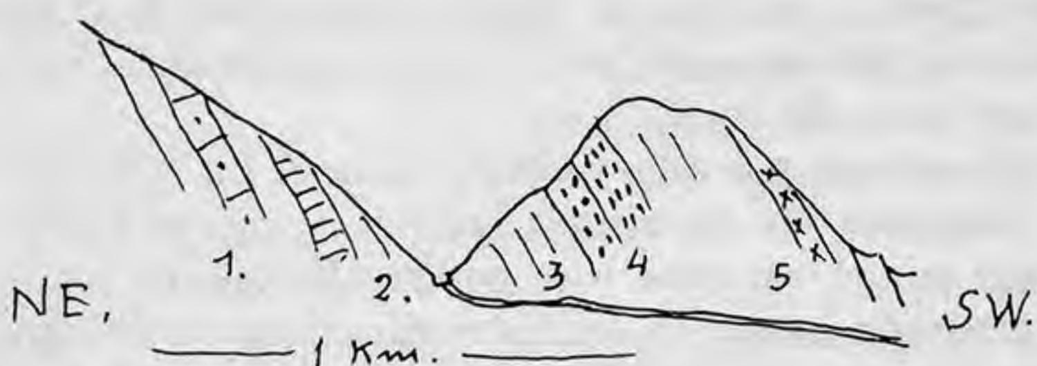
Fig. 4. — Perfil cortado por el barranco Carbo, a SW. es flanco de sinclinal que, a NE. pasa a flanco anticlinal. 1 calizas margosas con fósiles; 2 arenas con episodios oscuros; 3 calizas grises; 4 calizas rojas hematoideas; 5 calizas dolomíticas, amarillas con bivalvos
