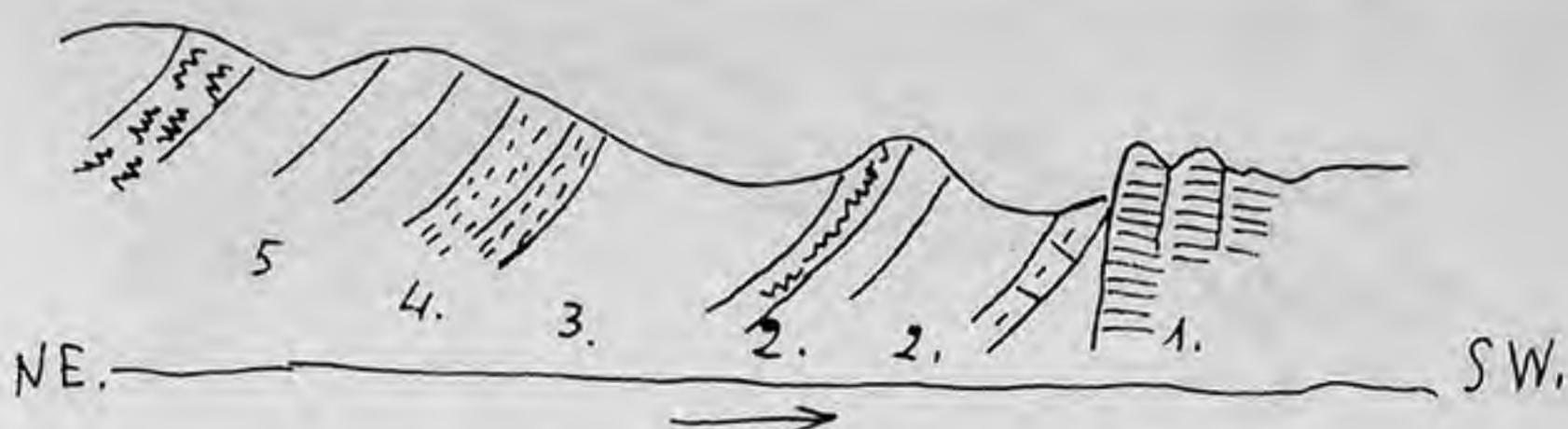
Fig. 3. — Perfil de la ladera izquierda del barranco Carbo, poco después de Villahermosa. Discordancia angular entre muschelkalk y aptiense. 1 calizas del muschelkalk; 2 calizas del aptiense; 3 margas con orbitolinas y ostreas; 4 calizas rojas; 5 calizas con nerineas. — El cretácico formando flanco de sinclinal
